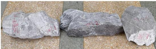
图1 进行云母含量测试的岩样
