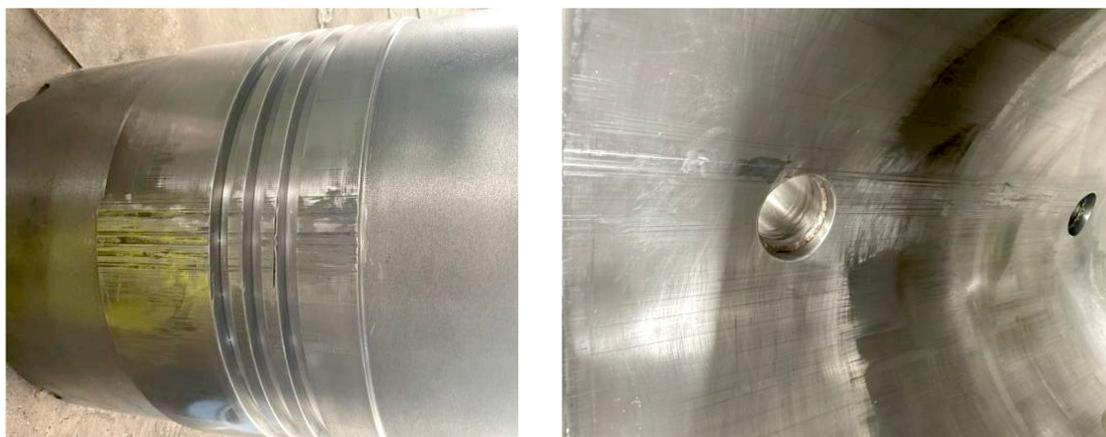
图 2 接力器活塞、缸体拉伤照片
