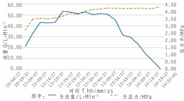
图2 II序孔P-Q-T曲线图
