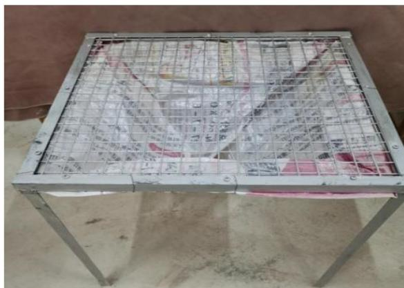
图 2 脱水支架照片
