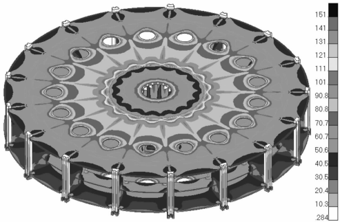
图 2 飞逸工况下转子支架应力示意图
