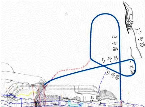
图4 可研阶段左岸上缆机平台道路布置
