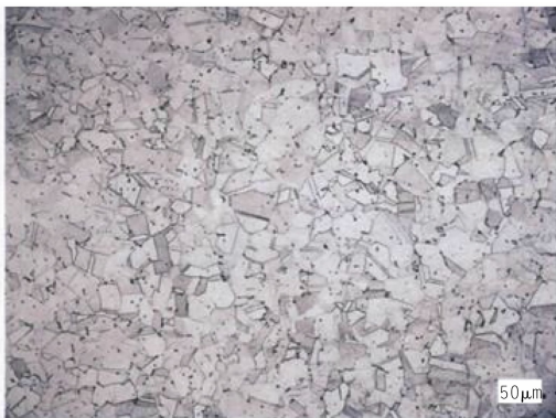
图2 断裂螺栓金相组织形貌图
