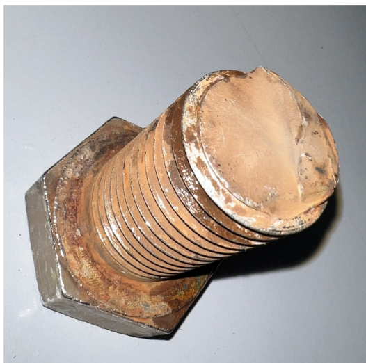
图1 断裂螺栓断面图
