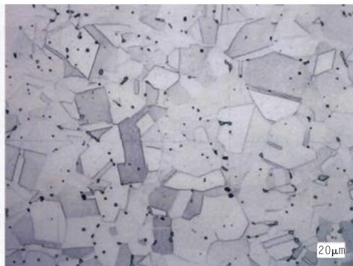
图2 断裂螺栓金相组织形貌图
