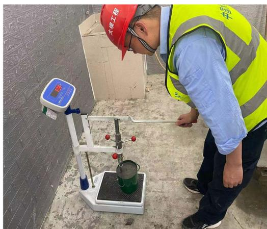
图 3 贯入阻力仪室内测试照片
