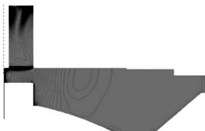
图 3 不带泵板顶盖取水
