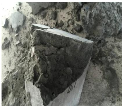
图2 破型后混凝土内部气泡
