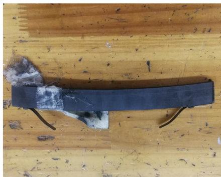
图7 上导接触式油挡取下的碳精块
