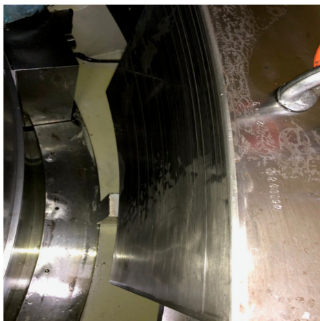
图 9 1号机9号上导瓦瓦面
