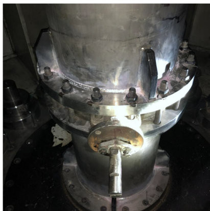
图 12 转子中心体内大轴补气蝶阀
