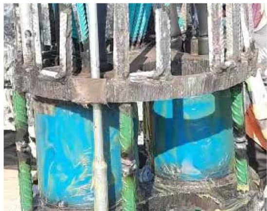
图 5 顶部位移监测杆
