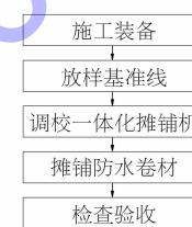
图3 防水卷材一体化摊铺机施工工艺流程图
