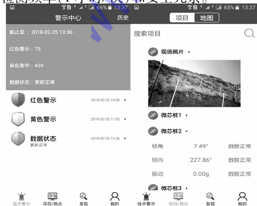
图3 猴子岩开顶滑坡体微芯桩实时监测预警平台
