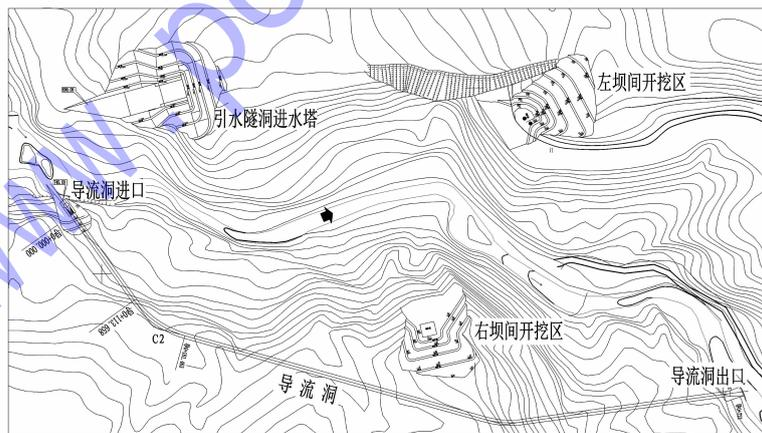
图1 导流洞平面布置图
