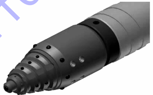
图3 不排土挤密钻头仿真模型示意图
