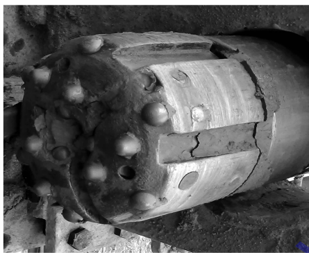
图6 贯通式反循环排渣钻头实物图
