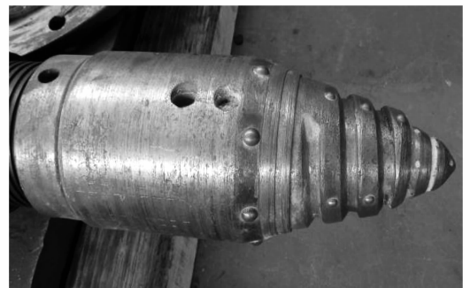
图4 不排土挤密钻头实物图
