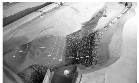
图 6 动床模型试验明渠出口及下游河床冲刷情况图 (Q = 11 400 m 3 /s)
