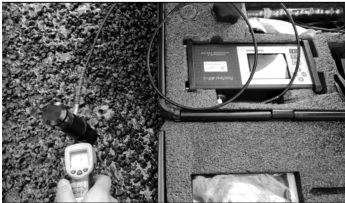
图2 应力吸收黏结层黏结力检测图
