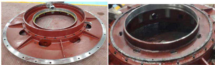
图2 推力头外的梳齿密封环切除前后
