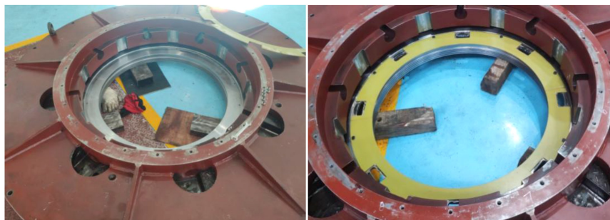
图3 上导瓦支撑板钻孔前后
