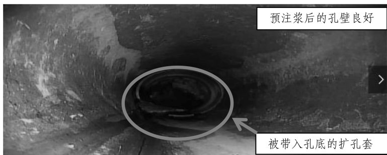
图3 钻孔孔内摄像图
