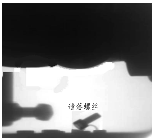
图 5 罐体内螺丝遗落
