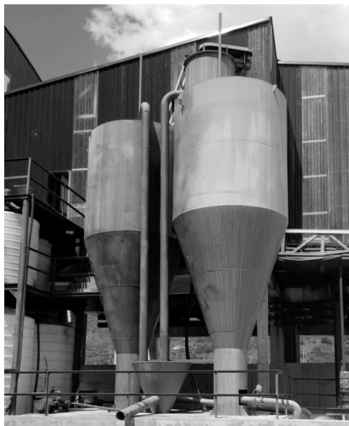
图5 微固车间旋流浓密分离罐现场照片
