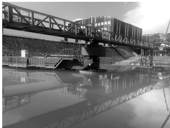
图6 新型辐流浓密机现场照片
