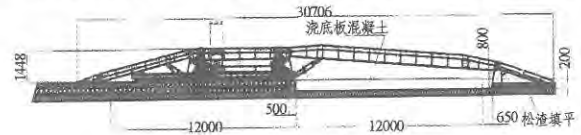
图1 栈桥纵剖面结构图(单位:cm)
