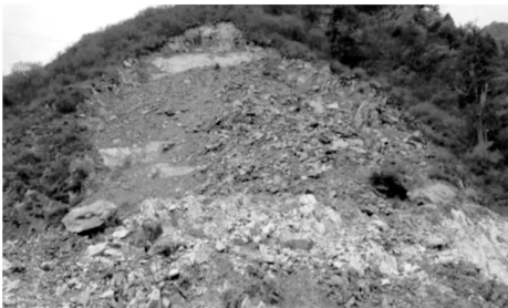
图 2 响水沟料场后缘松动岩体图
