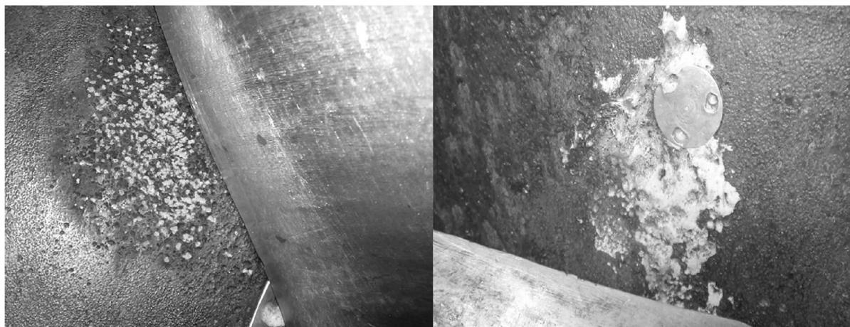
图1 转轮体空蚀处理前及运行多年后的对比图
