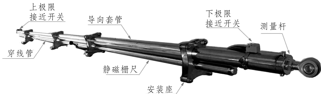
图 3 CWY-CB1-4500-1S1-411-10 型静磁栅闸门行程传感器示意图
