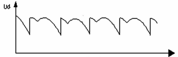
图 4 2VD 管和 RTO 损坏而断桥时的负载波形图
