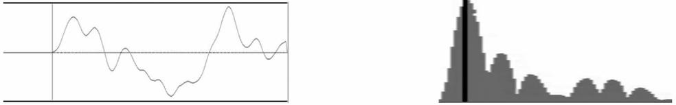
25 m 处波形及主频图(声时 4.00 ms,波速 2 850 m/s,主频 70 Hz)
