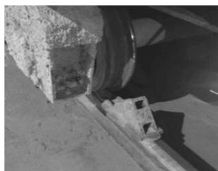
图3 铁鞋制动
