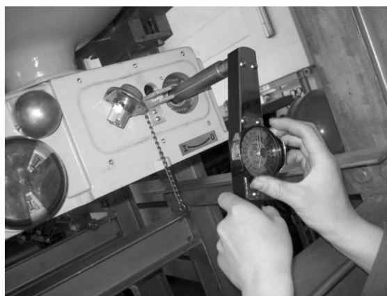
图5 整体力矩负载测试图
