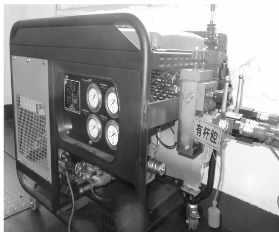
图2 应急泵站实物图
