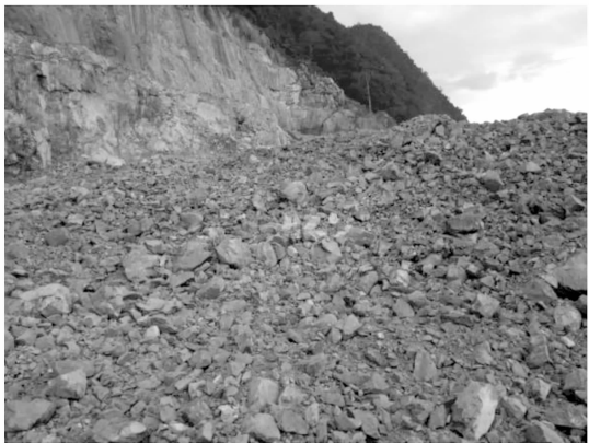
图 2 使用水介质换能爆破出的块度效果图
