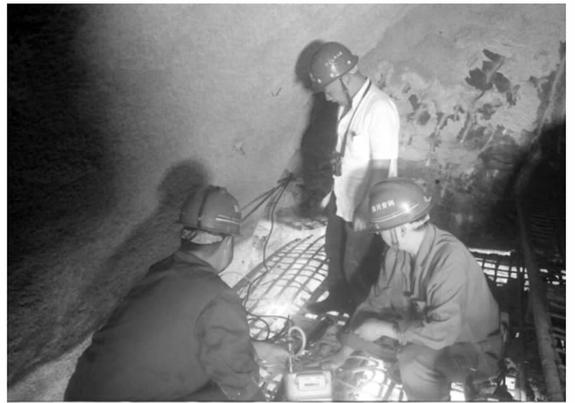
图1 瓦斯涌出量检测图
