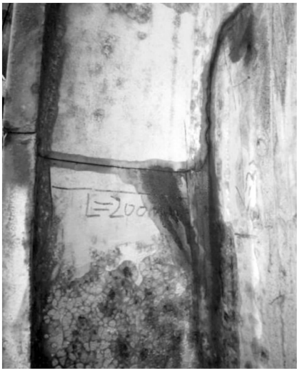
图 1 转轮室产生裂纹部位及长度
