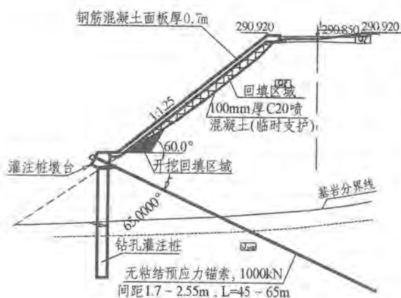
图1 锚索孔布置形式示意图
