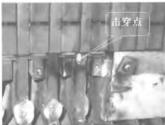
图3 A相117号槽上层击穿点示意图
