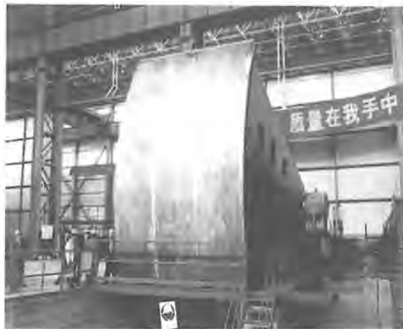
图2 反弧门动态模拟启闭试验示意图
