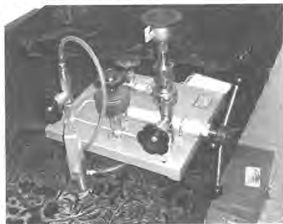
图1 现有渗压计扣紧装置与加压装置软连接图
