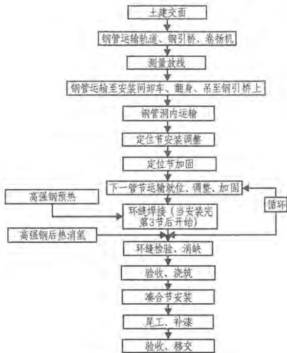
图 4 压力钢管安装施工程序图
