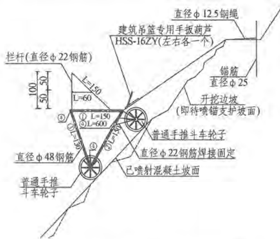
图3 喷射混凝土施工小车侧面示意图
