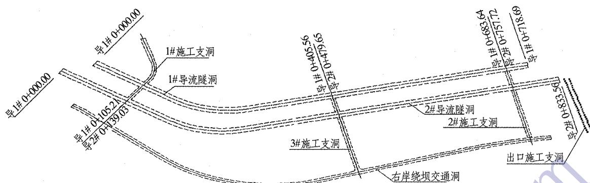
图2 导流隧洞施工支洞优化布置示意图
