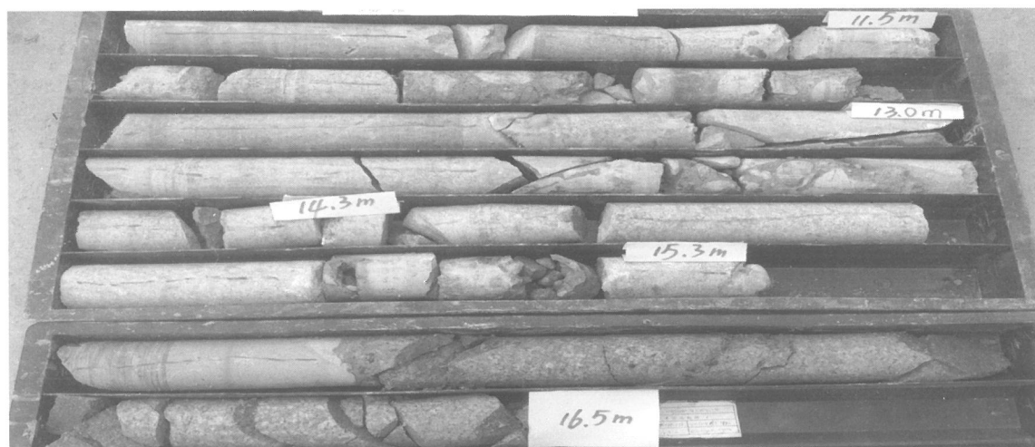
图 4 纵向围堰 3#取芯孔芯样图
