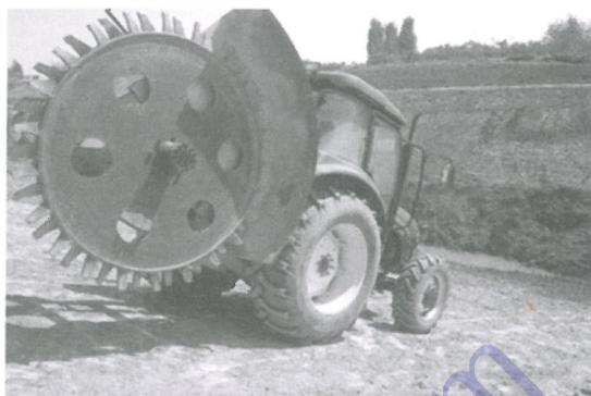
图1 改造后的拖拉机式刻槽机
