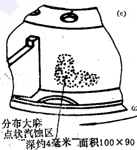
(c) 正常对称筋板隔腔中,圆筒表面上的汽蚀损坏,对应 80连通
